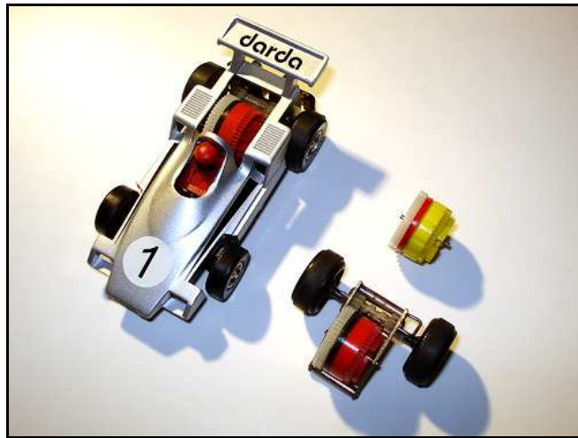
Bild 1: Austausch des Federgehäuses
